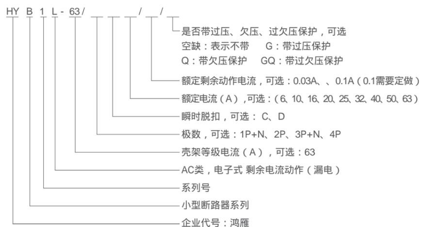
注：过压保护、欠压保护、过欠压保护电压等级可选AC220V、AC380V。
