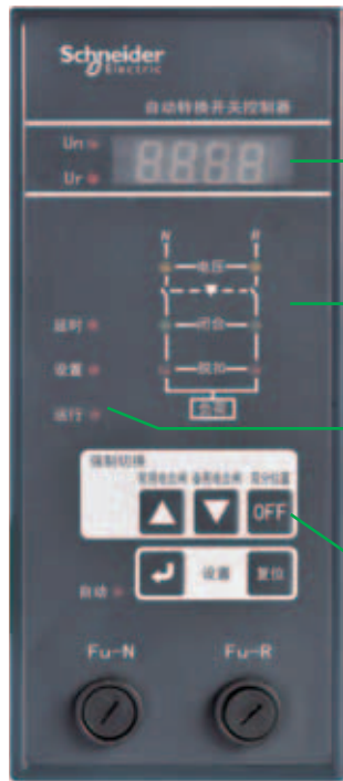
B型控制器适用于1-63A (执行单元为iC65微型断路器)
