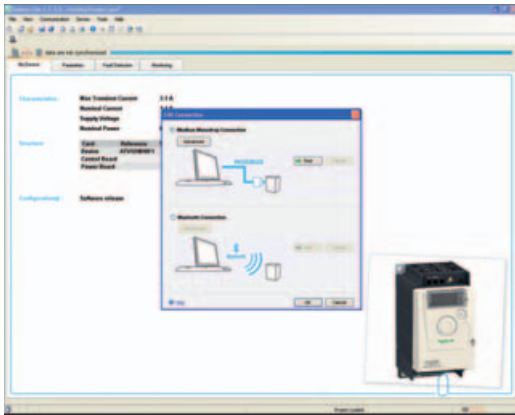
将SoMove软件连接至ATV12变频器的示例
