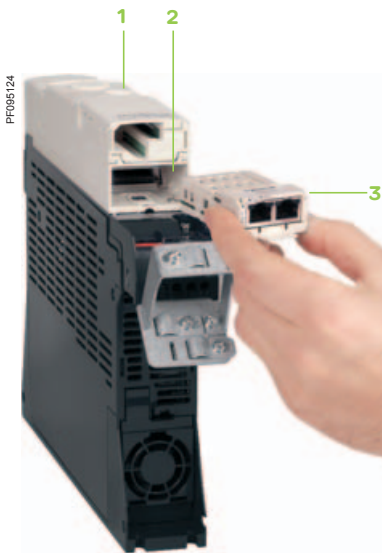
安装通信卡3示例(底面图)
