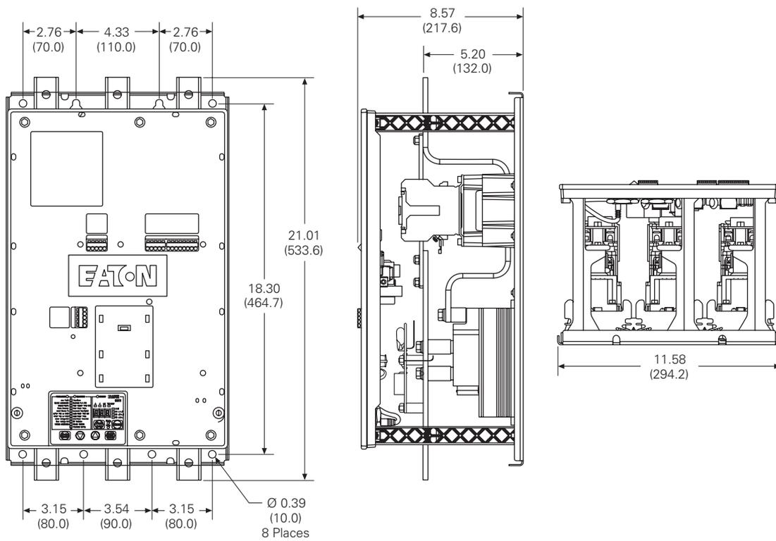
概略尺寸: 英寸 (毫米)
