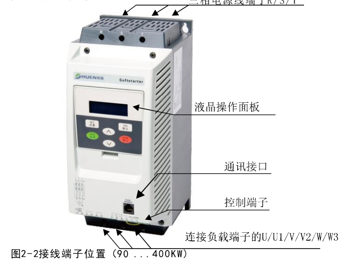
图2-2接线端子位置 (90...400KW)
