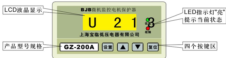
**U 2 1** LCD第一位U 为功能代码字符，后三位参数 2 1 3 为第一位 U 代码功能的参数值。
